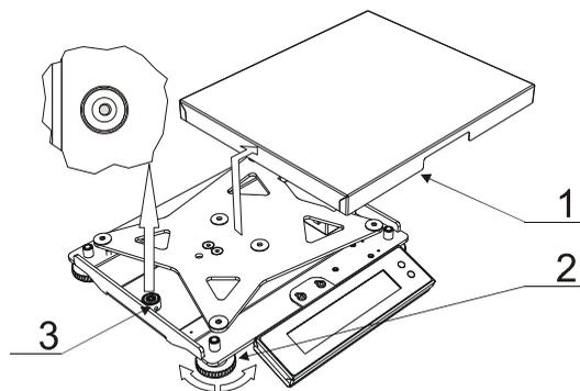
Далее необходимо установить весы на ровную горизонтальную поверхность, снять грузоприемную платформу 1 и вращением опор 2 добиться того, чтобы пузырек уровня 3 находился точно по центру, как показано на рисунке.
