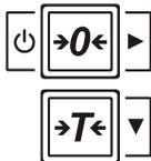
Клавиатура весов состоит из двух клавиш (см. рисунок), поэтому для обеспечения должной функциональности устройства клавиши выполняют различные действия в зависимости от текущего режима весов (см. таблицу 3), кроме того действия, выполняемые по нажатию клавиш, зависят от продолжительности нажатия клавиши: длинное нажатие или короткое (см. таблицу 2).
