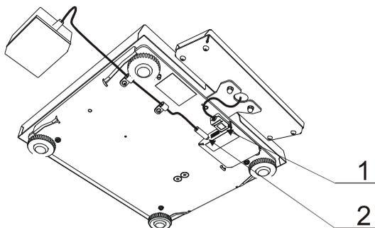
При подготовке весов к работе следует убедиться, что модуль индикации и клавиатуры подсоединен к грузоприемному устройству с помощью разъёма 1, а питание весов – с помощью разъёма 2 (micro USB и mini USB)\*, как показано на рисунке.
